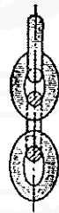
ภาพที่ 12 โซ่ที่ใช้ในการยกแบบ Coil Chain
