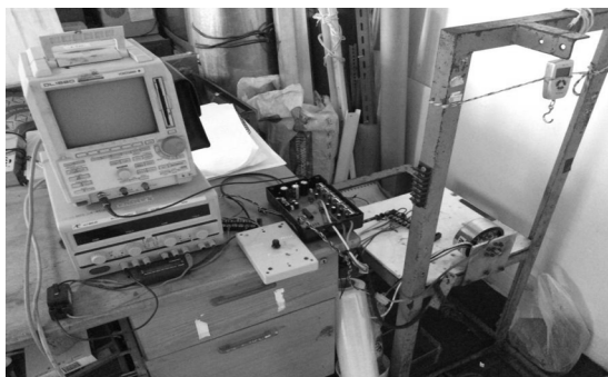
ภาพที่ 5 อุปกรณ์ที่ใช้ในการทดลองปรับตำแหน่ง Hall Effect Sensors
