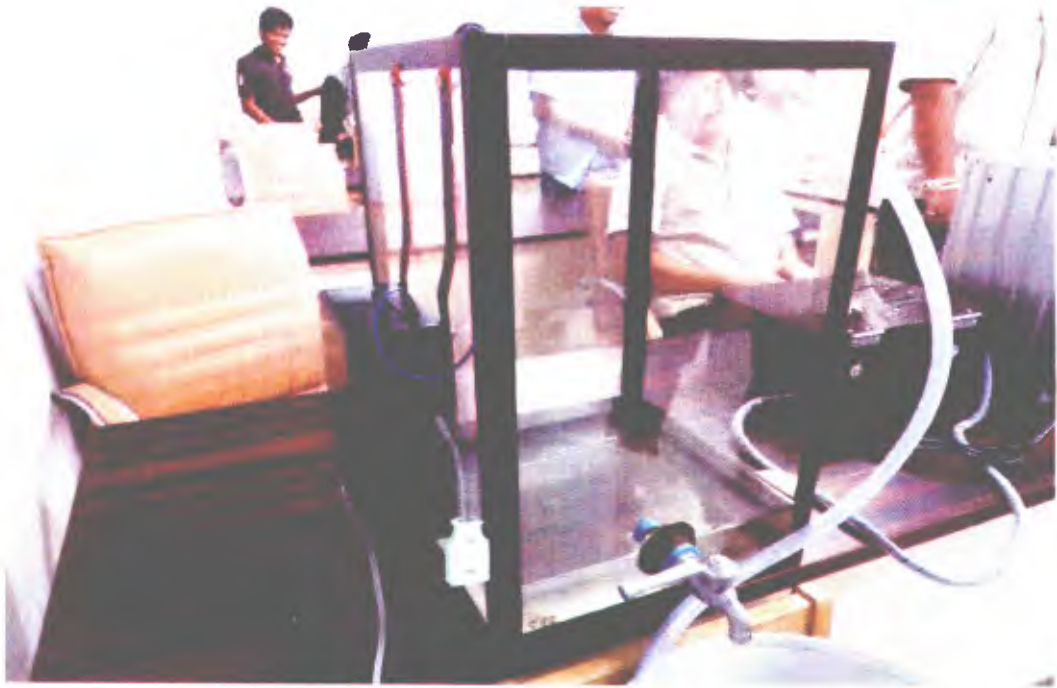
ภาพที่ ค.1 ชุดฝึกอบรระบบควบคุมระดับน้ำแบบอัตโนมัติที่ใช้ในการเก็บข้อมูลวิจัย
