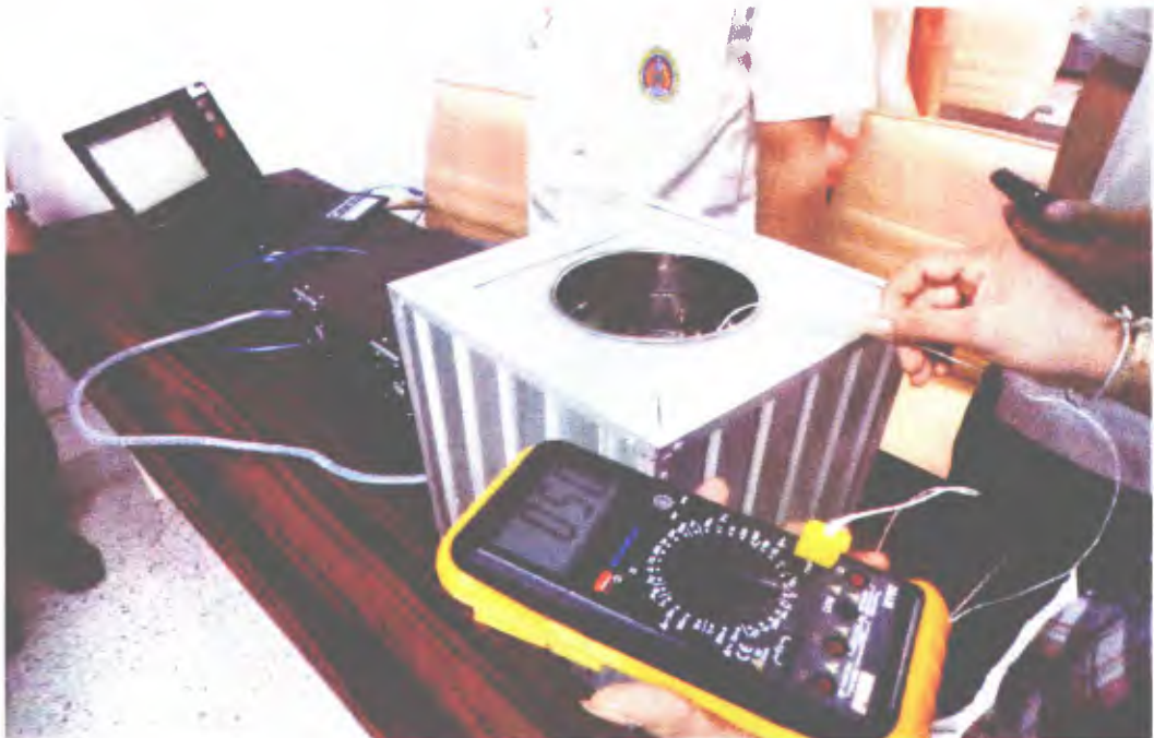
ภาพที่ ค.6 ชุดฝึกอบรมระบบควบคุมอุณหภูมิแบบอัตโนมัติที่ใช้ในการเก็บข้อมูลวิจัย
