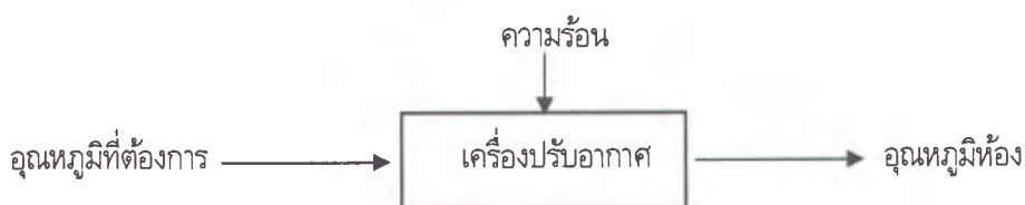
ภาพที่ 2 การควบคุมอุณหภูมิห้องด้วยเครื่องปรับอากาศ
