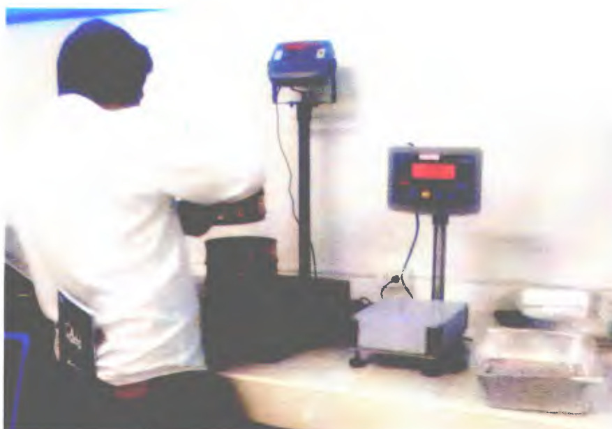
ภาพที่ 5 ชั่งน้ำหนักตะแกรงเพื่อหาค่าสัดส่วนละเอียดของทรายและหินฝุ่น
