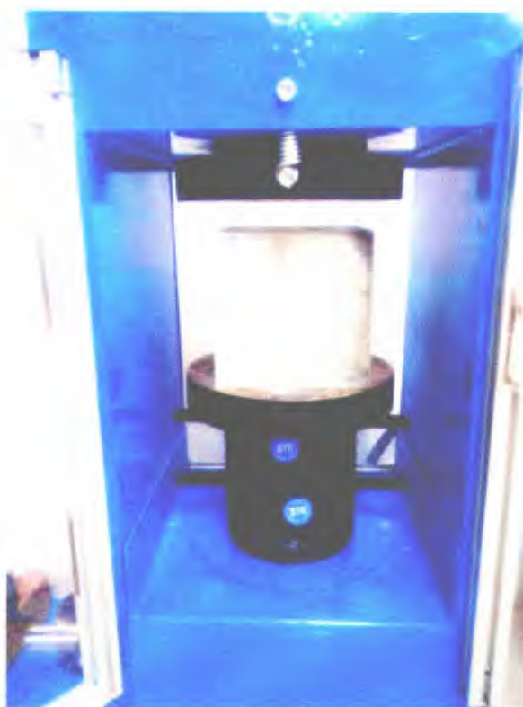
ภาพที่ 3.11 วัดขนาดหน้าตัดผิวหน้าลูกปูน แล้วนำเข้าเครื่องทดสอบ
