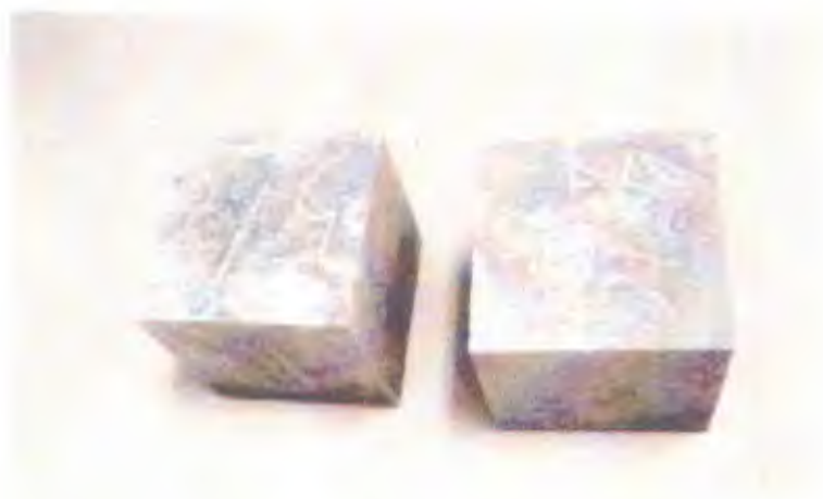
ภาพที่ 3.10 เมื่อครบอายุบ่ม นำลูกปูนขึ้นจากน้ำ วางทิ้งไว้ให้แห้ง
