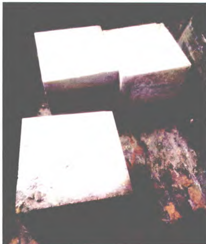
ภาพที่ 10 ลูกปุ่นหลังทำการทดสอบ
