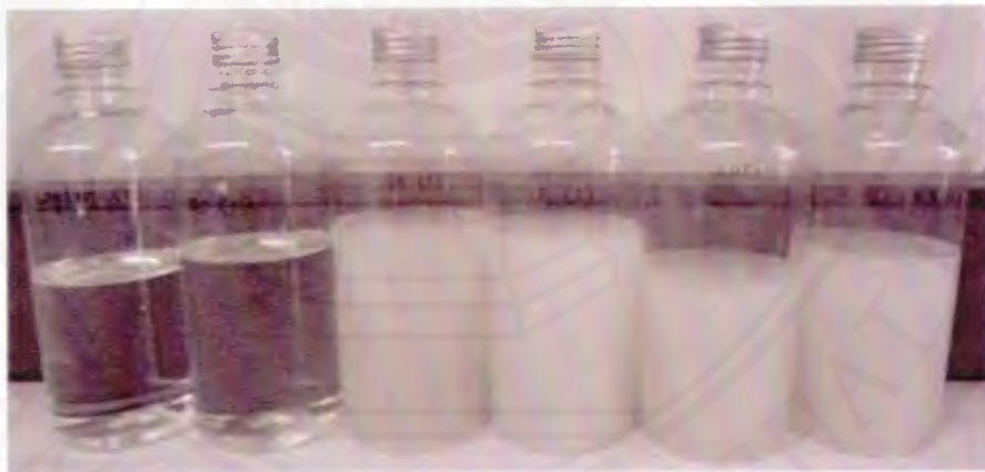
ภาพที่ 4.18 ลักษณะของน้ำมันมะพร้าวบริสุทธิ์ที่คัดแปลงโครงสร้างโดยเติมกลีเซอรอล และเอนไซม์ไลเปส D ที่ระดับความเข้มข้นต่าง ๆ
