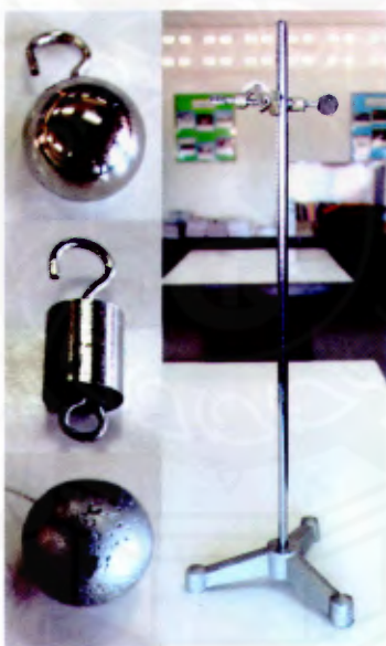
ภาพที่ 8 อุปกรณ์ประกอบชุดทดลองการเคลื่อนที่แบบลูกตุ้มอย่างง่าย
