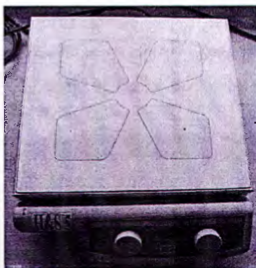
ภาพที่ 32 เตาไฟฟ้า (hot plate & stirrer) ยี่ห้อ Jenway รุ่น 1203
