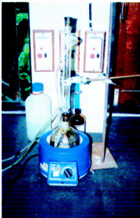
ภาพที่ 2.2 การให้ความร้อนโดยการกลั่นลำดับส่วน
